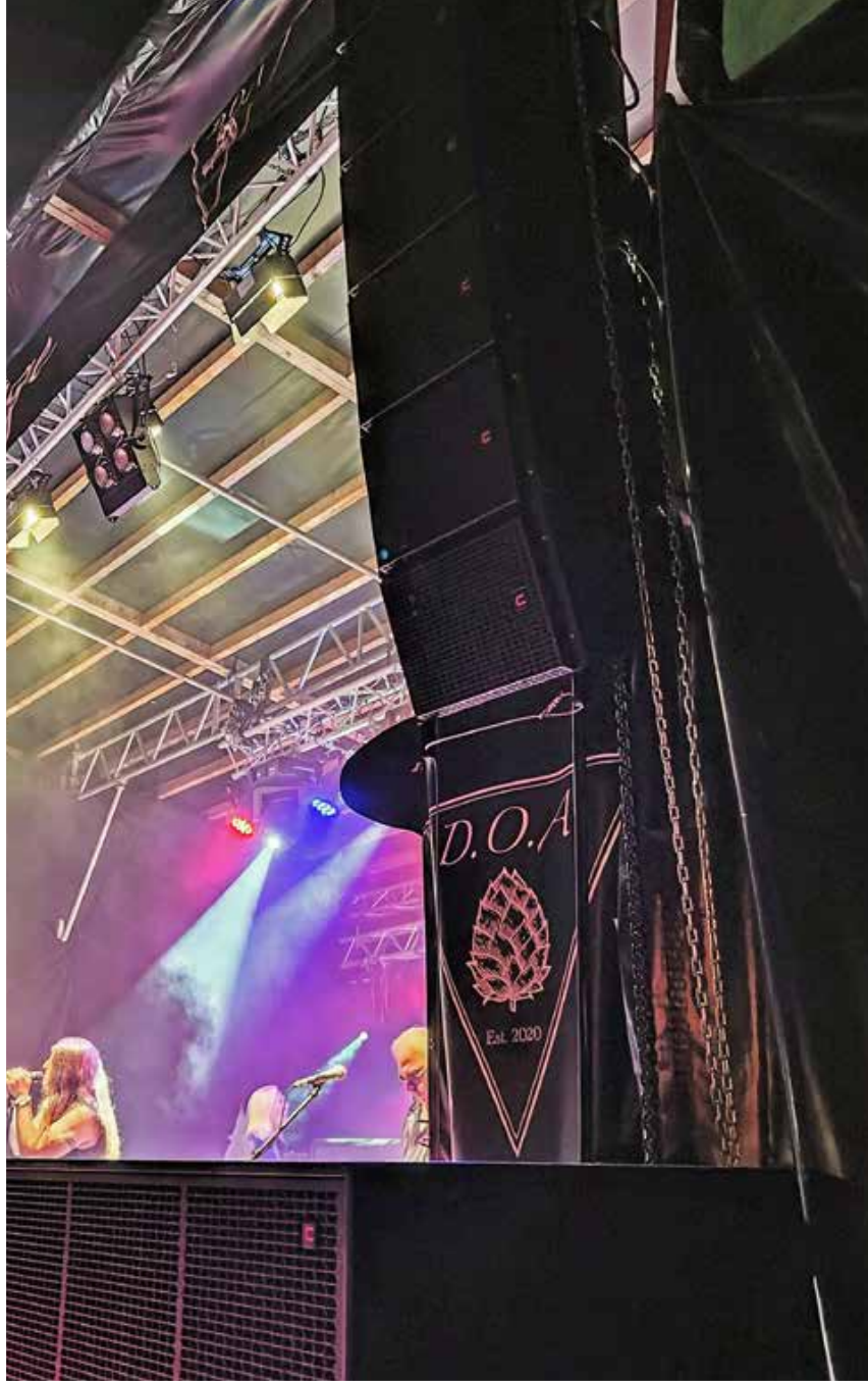
CELTO ACOUSTIQUE IR10+ 2-Wege Koaxial Line Array Modul
